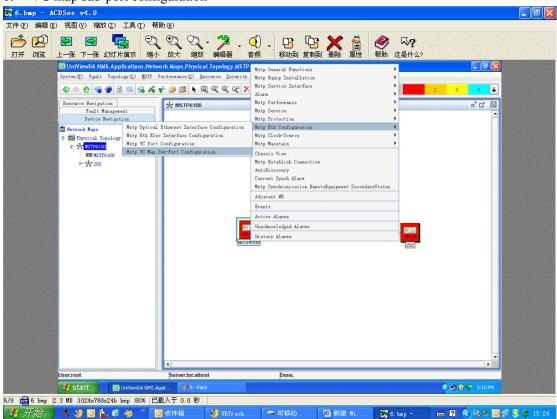
7. enable VC map sub-port 虚级联子端口使能
