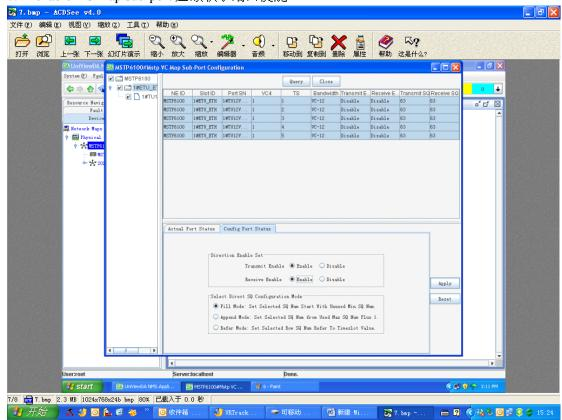
8. enable VC map sub-port of the other device 另一台设备的虚级联子端口使能
